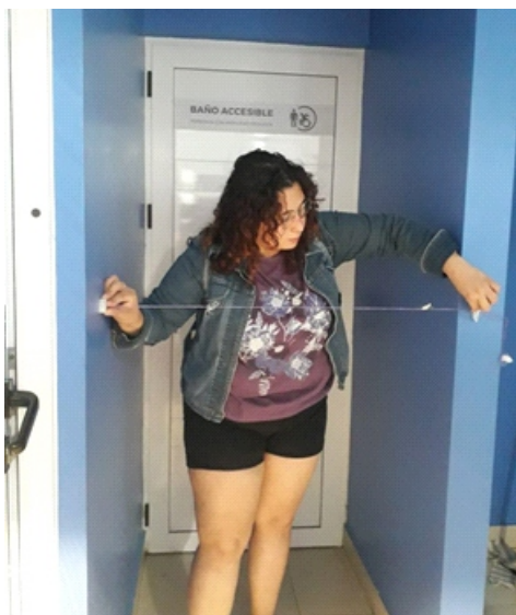
Fig 19. Verificación de medidas de ingreso a baño accesible. Fotografía propiedad de Fernanda Anaquín, alumna de Arte y Arquitectura Colonial.
