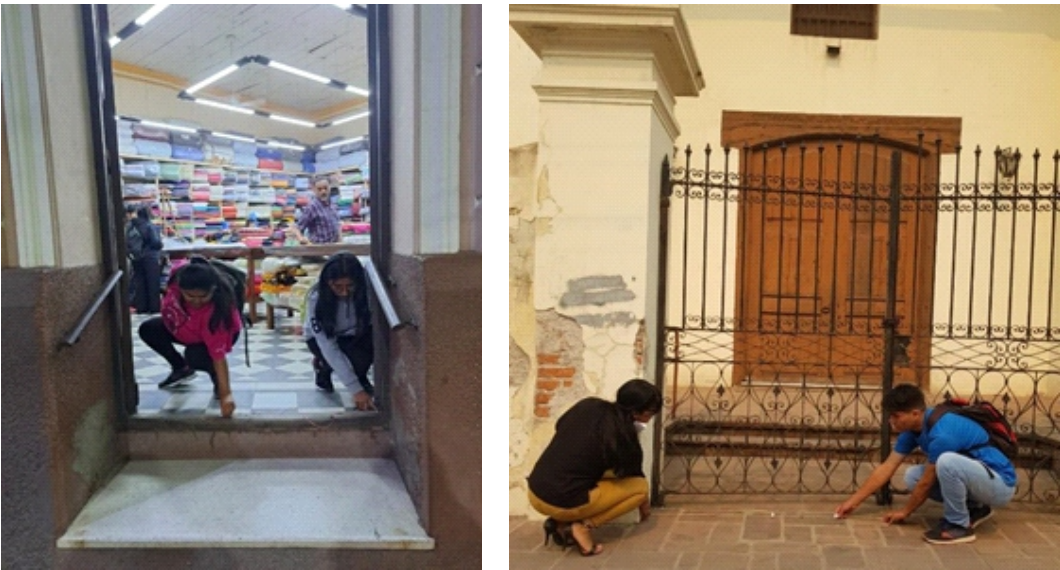
Figuras 7 y 8: Validación de las medidas de los vanos de las puertas de ingreso en edificios de valor patrimonial, utilizando el kit de accesibilidad (Casa Sadir img. izquierda, Capilla Sta. Bárbara Img. derecha). Fotografías tomadas de los alumnos de la Cátedra AAC.
