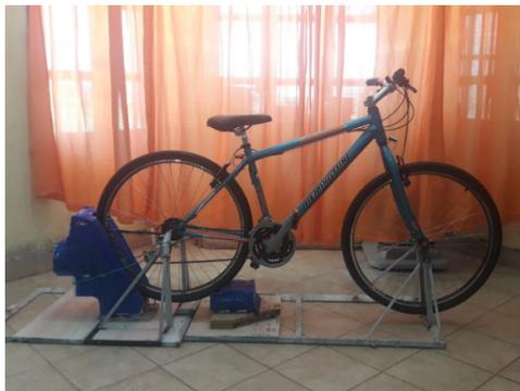
**Figura 2:** Prototipo de bicicleta como generador de energía
