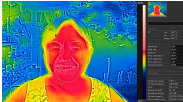
Figura N°11: Termografía de rostro humano con emisividad establecida en 0,98. Fuente: elaboración propia.
